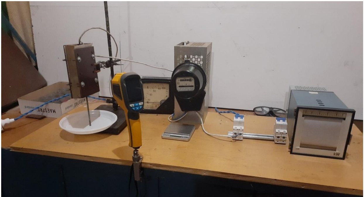
Рис 3.25. Фото лабораторної установки для зневоднення продуктів збагачення комбінованим способом
